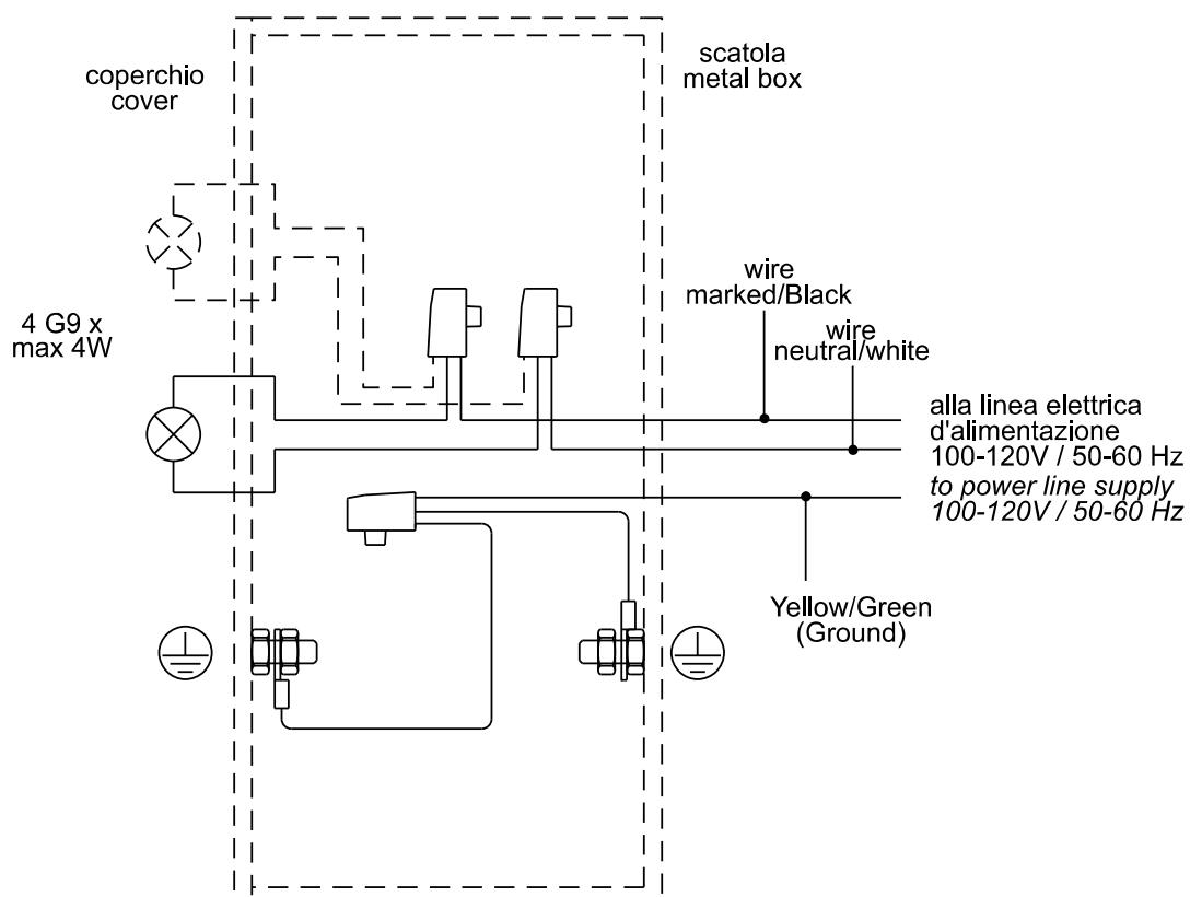
**CONNESSIONE:** Collegare il cavo (giallo/verde) di messa a terra con la messa a terra. Il cavo nero o marchiato con la fase, collegare il cavo bianco o trasparente con il neutro. ATTENZIONE:
