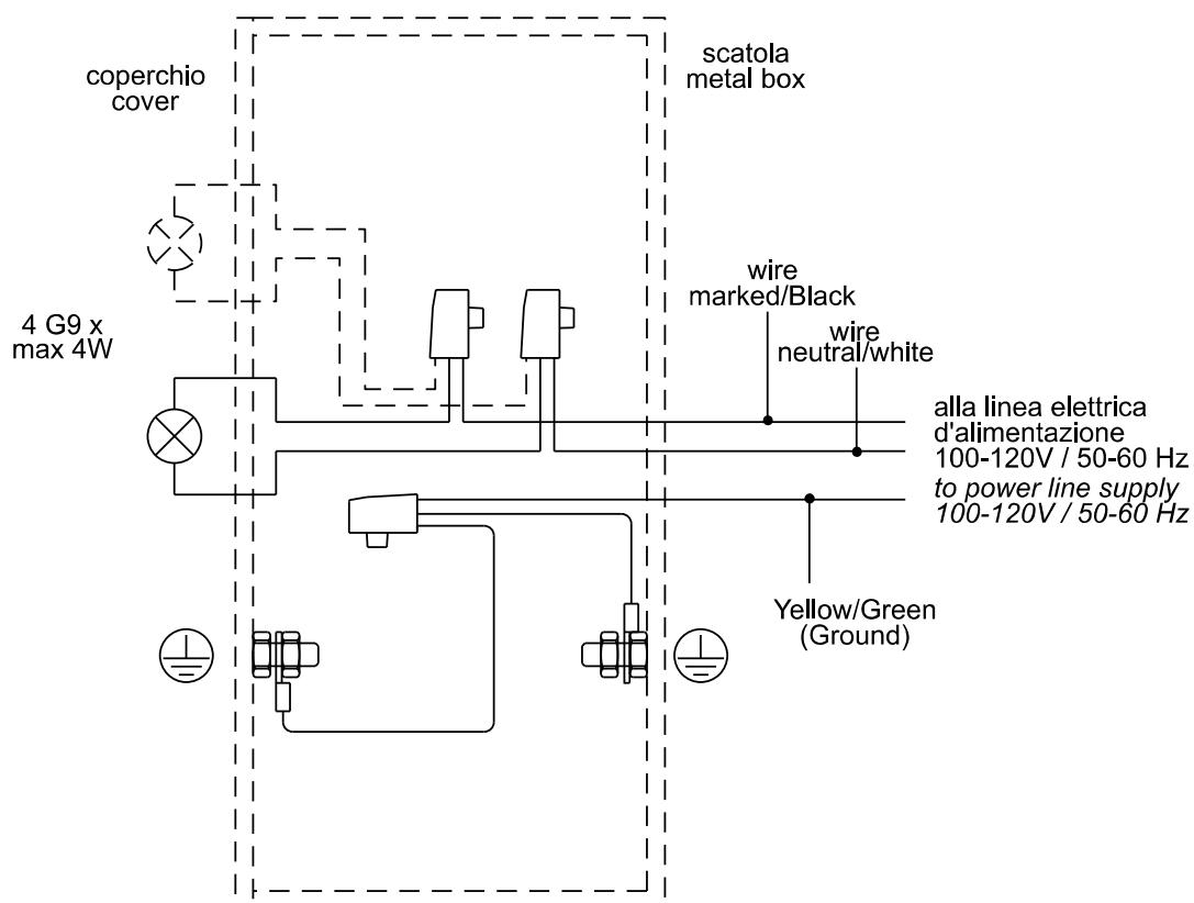
**CONNESSIONE:** Collegare il cavo (giallo/verde) di messa a terra con la messa a terra. Il cavo nero o marchiato con la fase, collegare il cavo bianco o trasparente con il neutro. **ATTENZIONE:** **RISPETTARE LA POLARITA'**: rischio di fuoco o schock elettrico. Questo prodotto deve essere installato da un elettricista qualificato.
